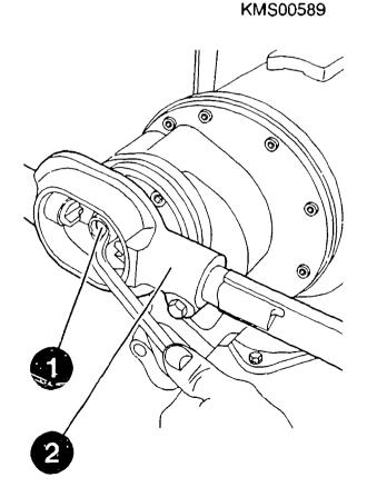
DISASSEMBLING REDUCTION GEAR (TYPE TF 0 001 613 ...)
